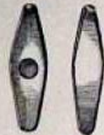
N° 87 (au 1/5) Massette de Cantoniers à 2 têtes, 5 h.
