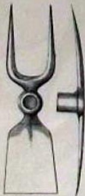
N o 110 (au 1/5) Serfouette, courte et fourche, 27 o /m.
